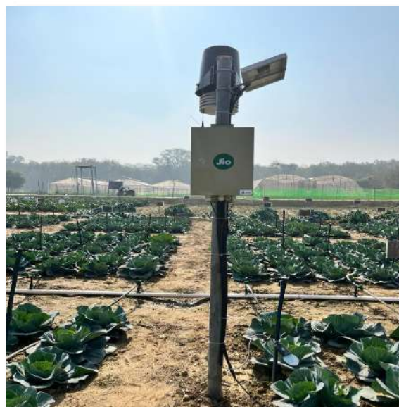
चित्र 2: सटीक खेती और विकास केंद्र परियोजना के तहत जल प्रौद्योगिकी केंद्र में लॉगर के साथ जियो कृषि मौसम स्टेशन की स्थापना
